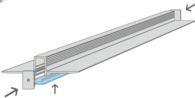
Applicare i tappi e se richiesto fissarli con le viti in dotazione, quindi inserire la copertura. Il tappo aperto è predisposto per l'uscita del cavo di alimentazione.
