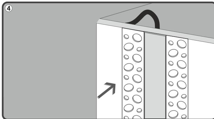
Posizionare il profilo nella fresatura precedentemente eseguita. Verificare che il profilo si accenda correttamente.
